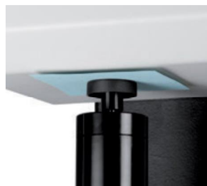
Probensockel mit geklemmter Probe
