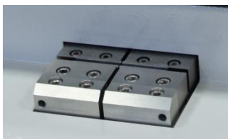
Offene Bauweise zum leichten Einlegen der Probe
