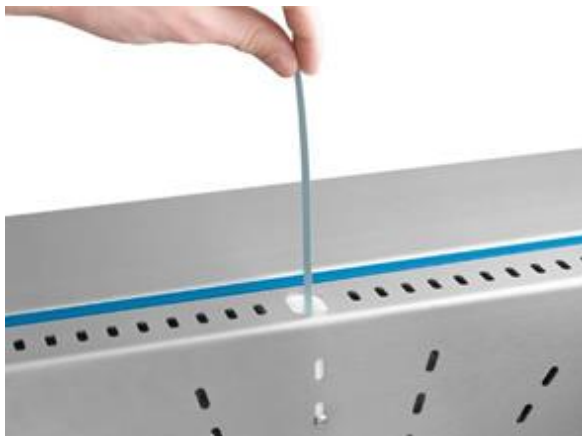
Einführen der Probe durch die Probenaufnahme Concora mit Slot für 12,7mm sowie 15mm erhältlich
